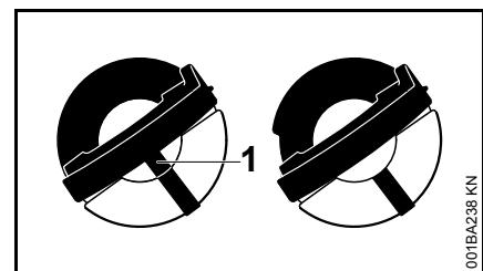
links: Unterteil des Tankverschlusses verdreht – innenliegende Markierung (1) fluchtet mit der äußeren Markierung
