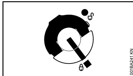
Le bouchon du réservoir est verrouillé.
