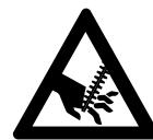
Bij draaiende motor de messen niet aanraken. Als de messen door een voorwerp worden geblokkeerd, de motor direct afzetten – dan pas het voorwerp verwijderen – **kans op letsel!**
