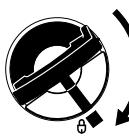
Dans le cas du bouchon de réservoir à ailette rabattable (verrouillage à baïonnette), le présenter correctement, le faire tourner jusqu'en butée et rabattre l'aillette.
