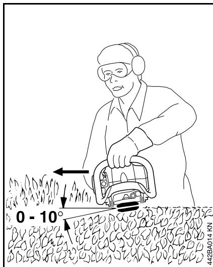
Schneidmesser in einem Winkel von 0° bis 10° ansetzen – aber waagerecht führen.
