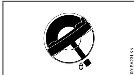
In deze stand staan de markeringen op de tankdop en de benzinetank met elkaar in lijn
