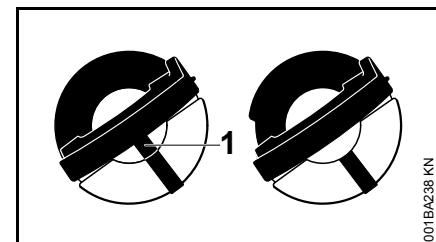
À g. : La partie inférieure du bouchon du réservoir est décalée – le marquage intérieur (1) coïncide avec le marquage extérieur.
