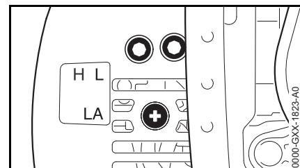
Die Vergasereinstellung ist so abgestimmt, dass dem Motor in allen Betriebszuständen ein optimales Kraftstoff-Luft-Gemisch zugeführt wird.
