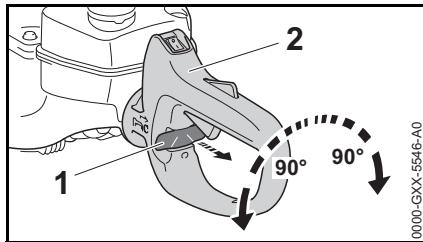
Voor het comfortabel geleiden van de heggenschaar bij alle werktechnieken kan de handgreep 90° links- en rechtsom worden gedraaid.
