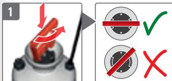
Pumpe korrekt entriegeln
